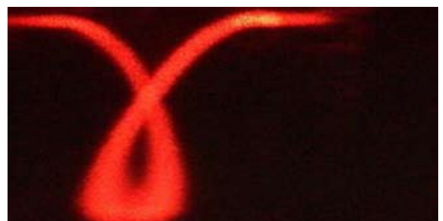
9 pav. 2D refraktograma, lazerinės linijos SLP praleistas virš ataušinto metalinio rutulio
