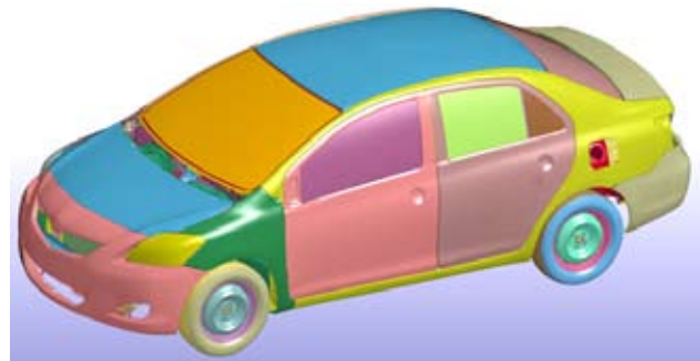
4 pav. Automobilio „Toyota Yaris“ baigtinių elementų modelis Šaltinis: sudaryta autorių.
