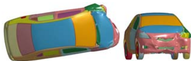
7 pav. Automobilio „Toyota Yaris“, važiuojančio 30 km/h greičiu, vaizdas po susidūrimo su nedeformuojama siena, kai persidengimas 25 proc.
