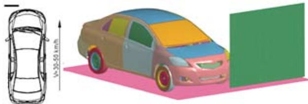
6 pav. Automobilio „Toyota Yaris“ vaizdas prieš susidūrimą su nedeformuojama siena, kai persidengimas 25 proc. Šaltinis: sudaryta autorių.
