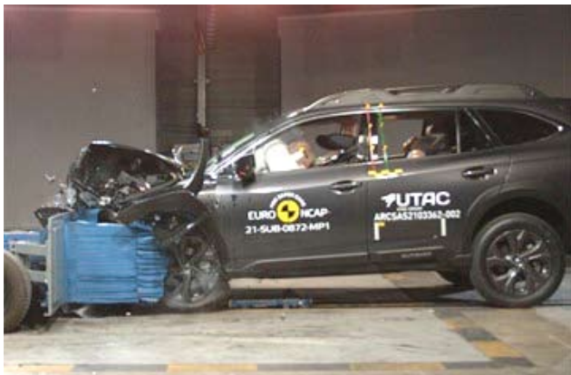
3 pav. „Euro NCAP“ realaus susidūrimo bandymas Šaltinis: Euro NCAP...2021.
