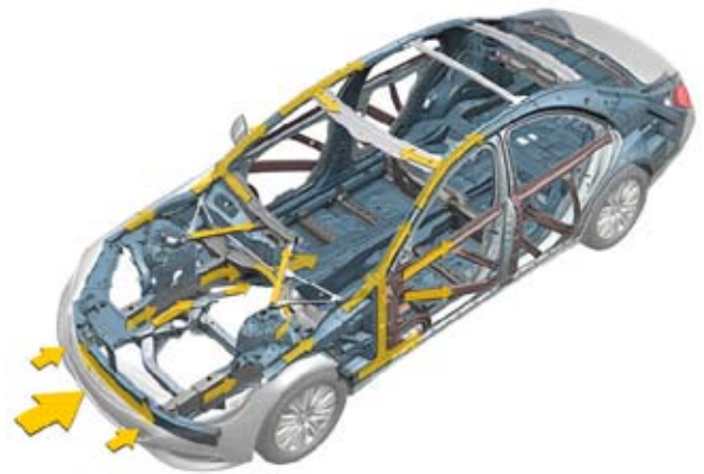
1 pav. Deformacijos keliai, sugeriantys priešpriešinio susidūrimo metu atsirandančią energiją
