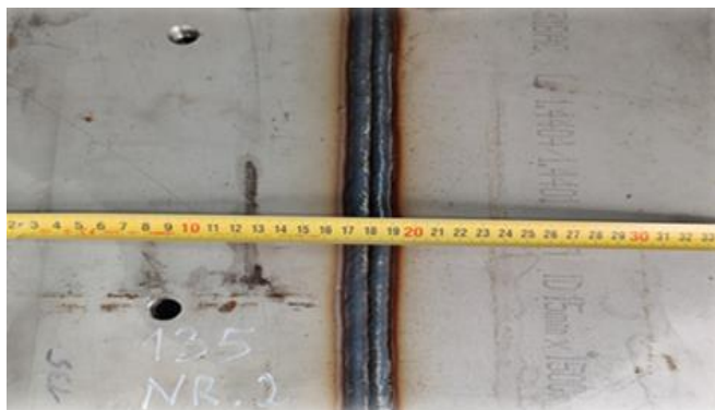
3 pav. Suvirintas 1.4462 ir 1.4404 plienų ruošinys Šaltinis: sudaryta autorių
