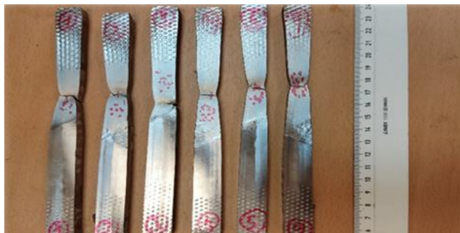
17 pav. Suirusių tempimo bandinių vaizdas
