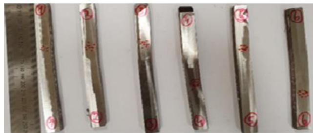
4 pav. Ruošiniai, supjaustyti į šešias dalis. Šie bandiniai skirtingai termiškai apdoroti Šaltinis: sudaryta autorių
